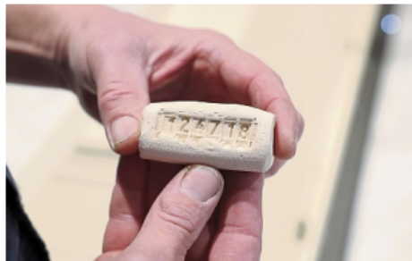
Zur eindeutigen Identifizierung der Asche: Auf jeden Sarg wird ein Schamottstein mit einer gravierten Nummer gelegt.
